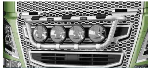
Rampe de feux calandre
