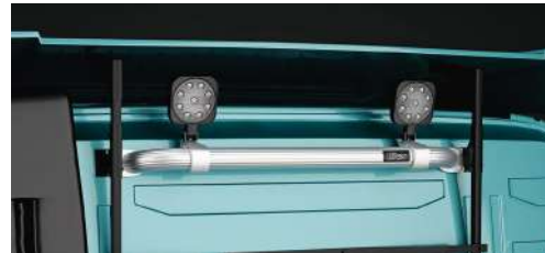
Rampe de feux arrière
